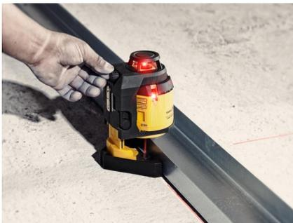
**MANUALALIGNMENT:** Per Drehknopf wird der Laser manuell auf die Markierung oder das U-Profil eingeschwenkt und so der rechte Winkel angelegt.
